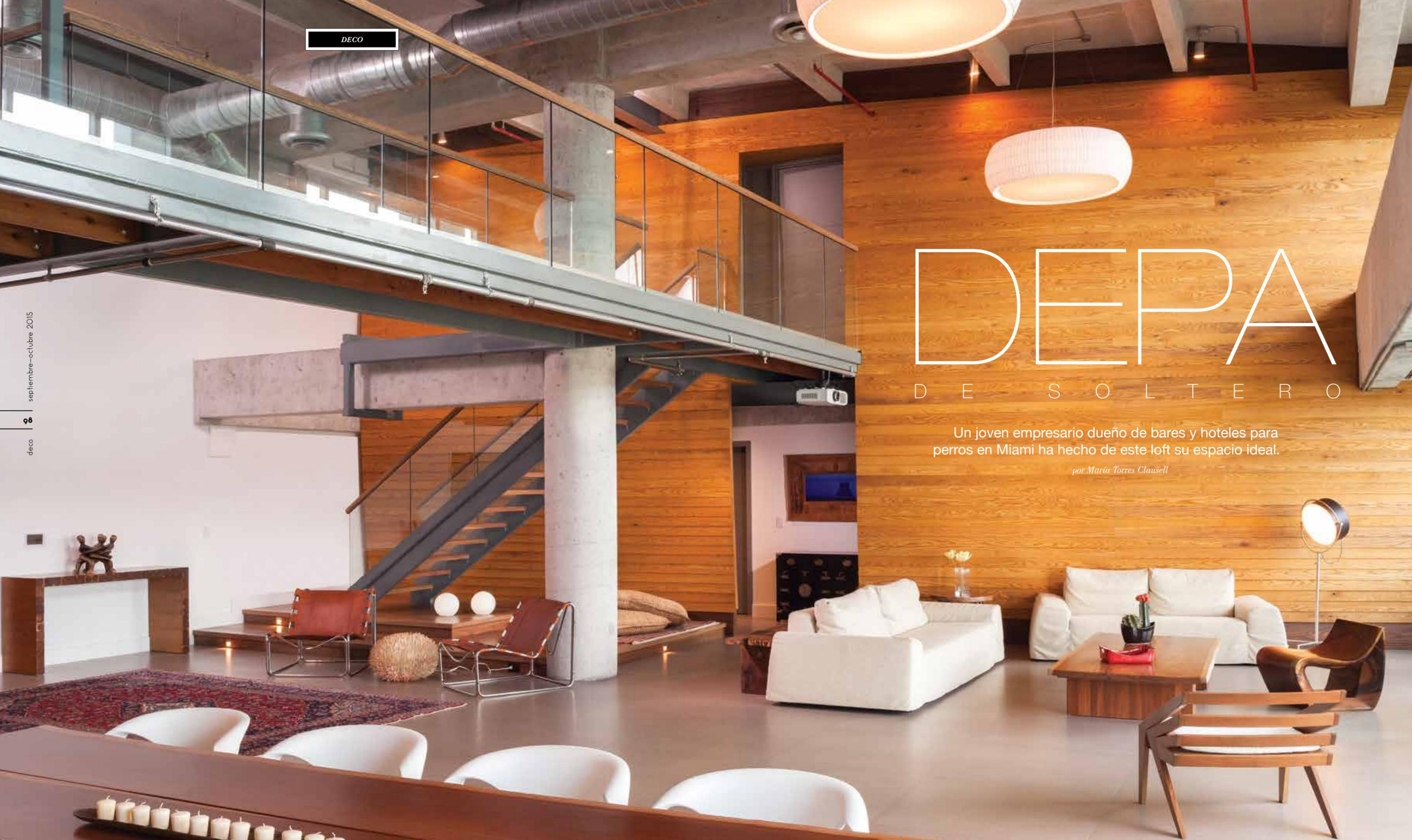
La estructura metálica del segundo piso fue diseñada para colgar del techo sin tener apoyos o columnas al piso, y no interrumpir la vista ni el espacio central del apartamento. Poltrona ASA diseñada por Bernardo Senna.
